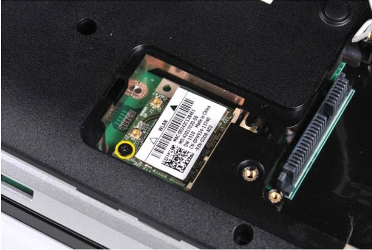
7. WLAN 카드를 시스템 보드의 커넥터에서 45도 각도로 밀어 꺼냅니다.
